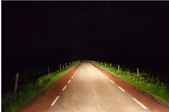
Foto: Eltenseweg in Beek. Belijning die reflecteert, het verloop van de weg is goed te zien is.
