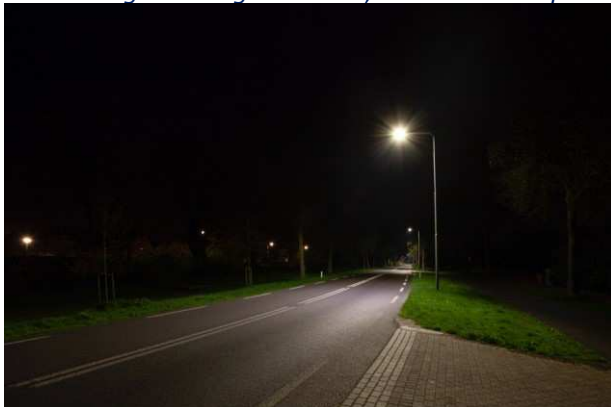
Foto: Hengelderweg in Didam; Licht brandt op 70% tussen 23.00 uur en 05.00 uur. Er is minder verkeer op straat, de ogen zijn gewend aan donker, minder lichthinder en we besparen energie.
