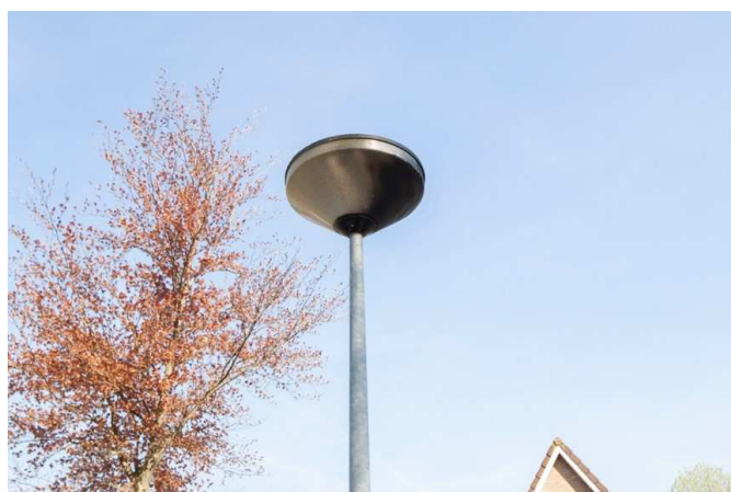
Foto: Klapproos in Didam, kap is zwart gemaakt vanwege hinder van het licht in de tuin/huis.
