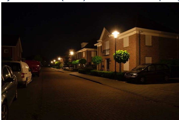
Foto: Pontilaan in Nieuw Dijk. Witte ledverlichting voor een goede kleur- en gezichtsherkenning.
