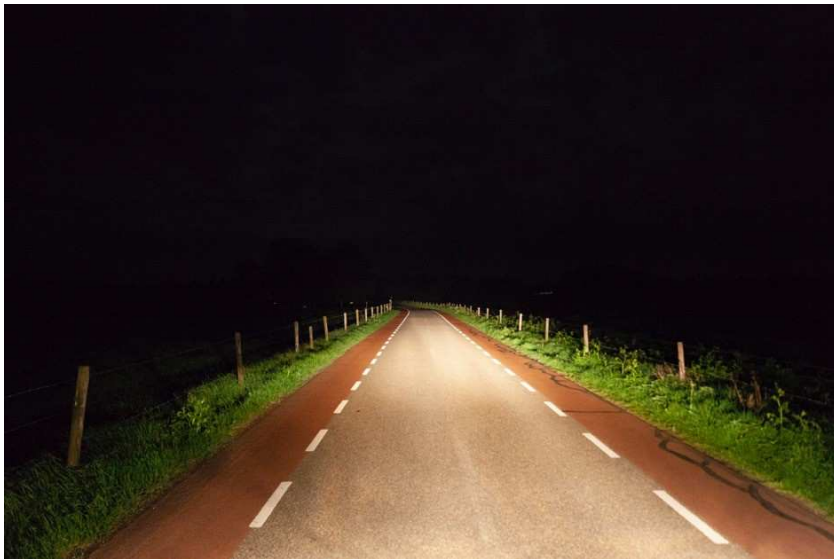
Foto: Eltenseweg in Beek, reflecterende strepen geven het verloop van de weg goed weer.
