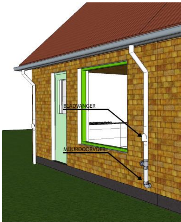
Figuur 1: Achterzijde tussenwoning met bladvanger en muurdoorvoer.
