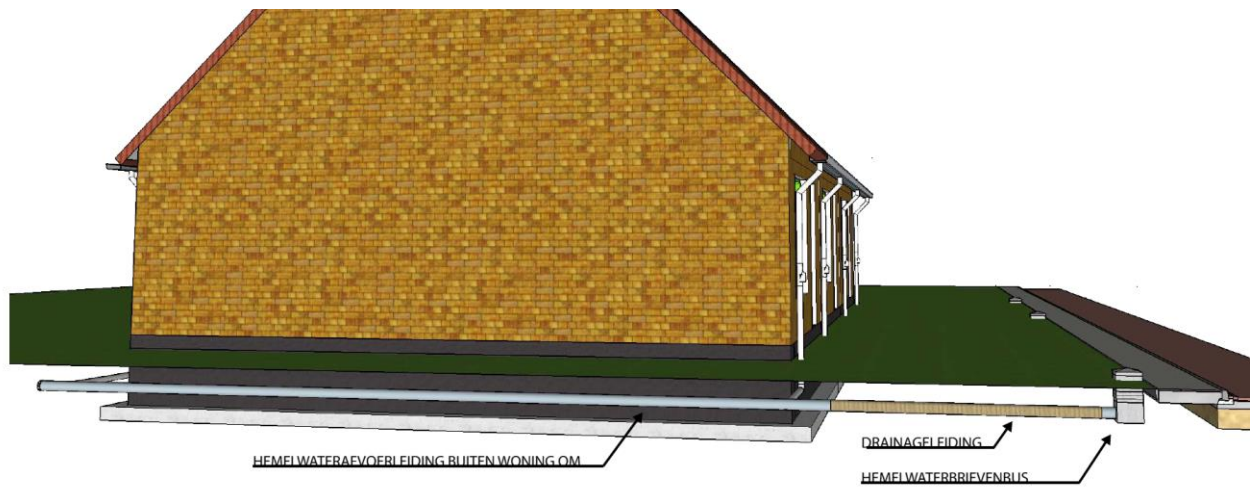
Figuur 3: Hemelwaterafvoer bij hoek- of vrijstaande woning
